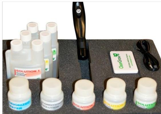
El analizador de nutrientes CleanGrow permite la medición rápida, fácil y simultánea de hasta seis iones en soluciones de múltiples iones. Basado en la ciencia analítica más avanzada de nanotubos de carbono.
